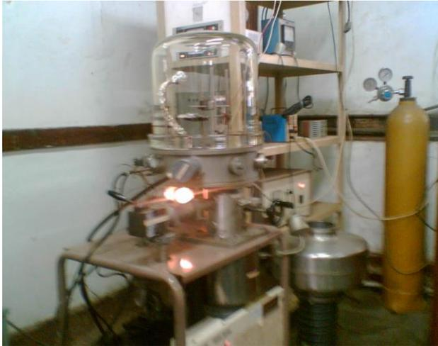
Gambar (8.14). Vakum evaporator tipe VPC-410 dari Ulvac Sinku Kiko .
